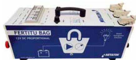
la portata è compresa tra 1 e 80 m<sup>3</sup>/ora. FertiTU BAG è dotato di un'alimentazione da 12 V, una centralina di controllo con avviamento e arresto automatici, una pompa in AISI 316 con pressione massima di 5 bar, valvola di non ritorno e sistema di allarme per mancata iniezione. La struttura è in alluminio per un peso complessivo di 10 kg.
