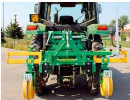
In questo modo il telaio traslatore guida la sarchiatrice tra le file correggendone costantemente la posizione. Il controllo della macchina viene effettuato dal sistema di guida elettronico posto in cabina, concedendo migliore confort all'operatore. La velocità di spostamento può raggiungere i 15 km/ora.
